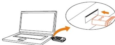
Αφαιρέστε το κάλυμμα της θύρας USB και συνδέστε το καταγραφικό στον Η/Υ σας. Το αρχείο PDF με τα καταγεγραμμένα δεδομένα θερμοκρασίας θα δημιουργηθεί αυτόματα και το καταγραφικό θα εμφανιστεί ως Αφαιρούμενη Μονάδα Δίσκου «Elitech LOG».
